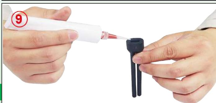
**9:** Versare il silicone RTV all'interno del foro principale della guaina in silicone.
