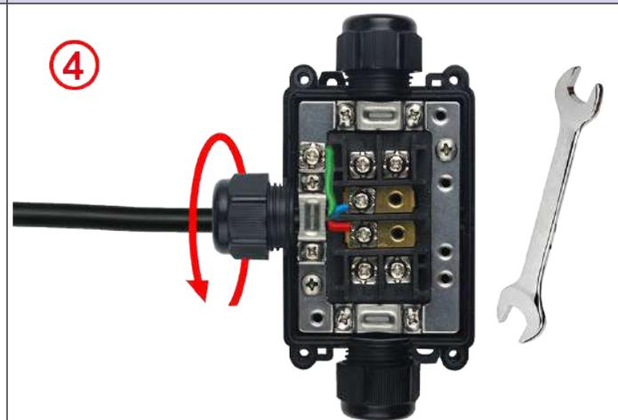
**4** : Far scorrere la guarnizione rotonda del cavo nel pressacavo e serrare il dado. Coppia massima 3N·m.
