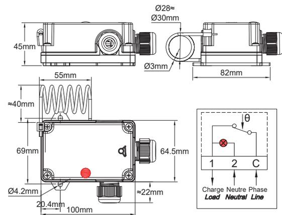
Esempio di montaggio a parete collegato alle scatole di connessione Y25 per la protezione antigelo delle acque zootecniche
