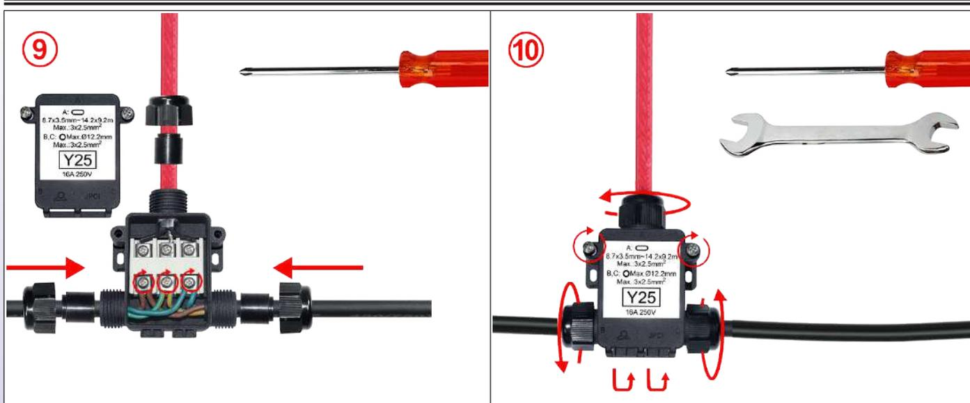
**9** : Inserire la parte spelata dei conduttori di alimentazione nei morsetti e serrare con un cacciavite. 2 conduttori all'interno di ciascun terminale, su ciascun lato della sella. Coppia di serraggio consigliata 1.2N·m.
