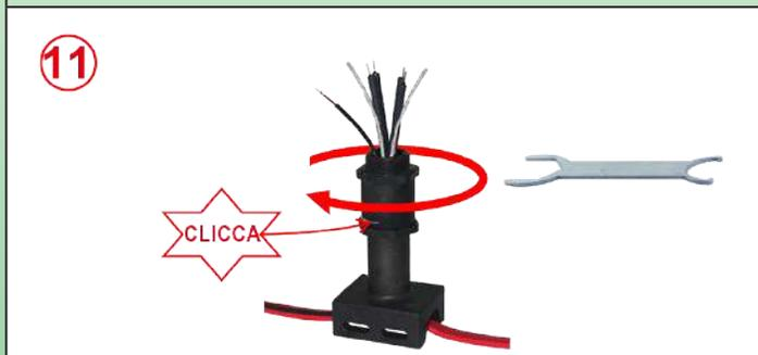
**11:** Comprimere la guarnizione avvitando la parte superiore del piede. Al termine del serraggio, una piccola molla viene a bloccare l'assemblaggio (per lo smontaggio, è necessario rimuovere questa piccola molla semicircolare). A questo punto è possibile installare il piedino in un foro di 32.5mm sul contenitore selezionato.
