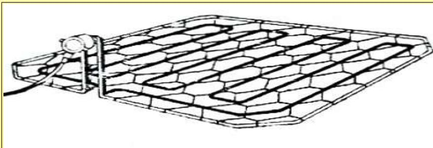
1956, esempio di griglia da 1.5m<sup>2</sup>, che supporta un elemento scaldante a guaina, per il riscaldamento degli strati in orticoltura. (1956 Electric heating in horticulture, Ultimheat Museum\*)
