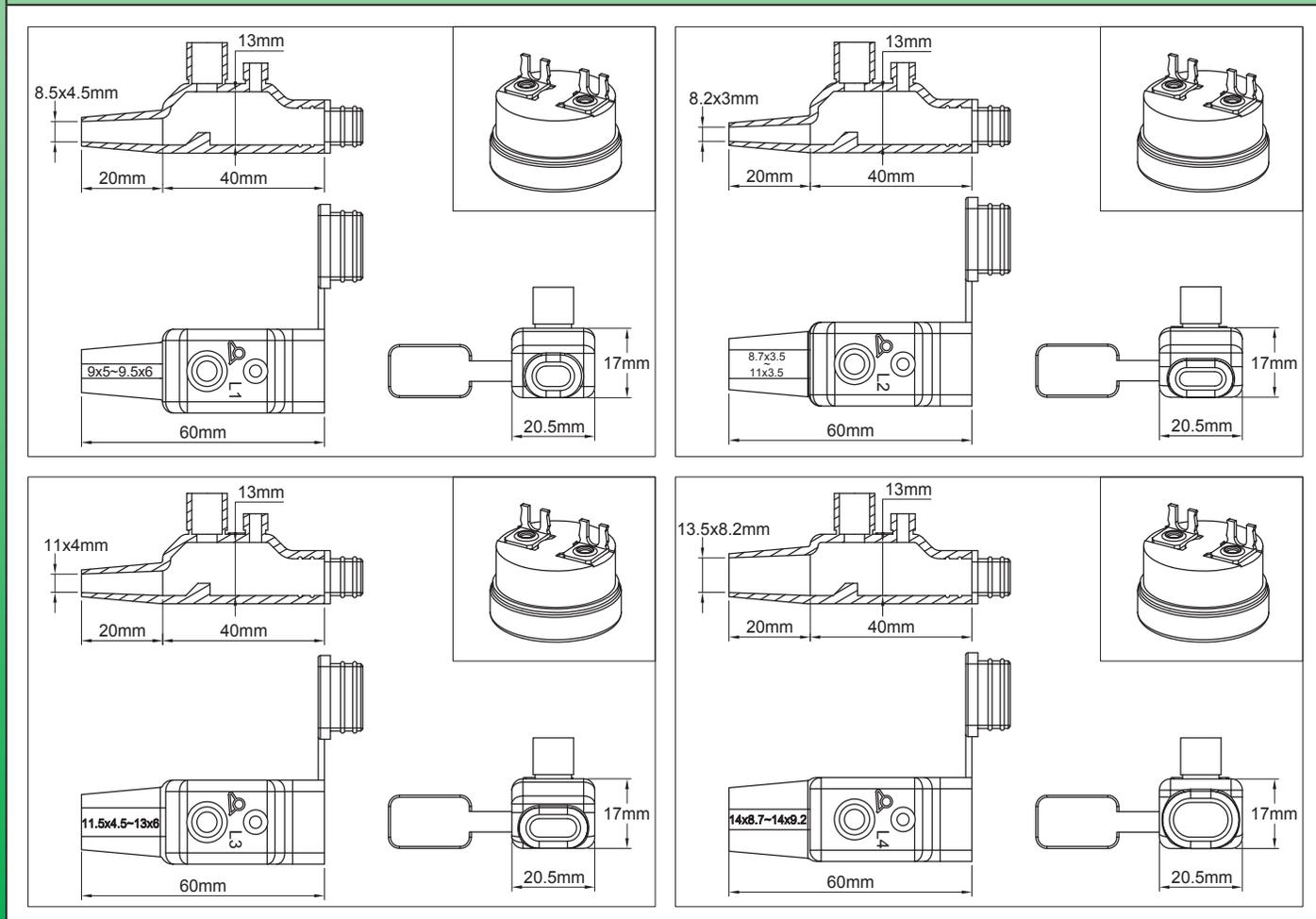
Guaine in silicone per il collegamento dei **cavi scaldanti e dei cavi di alimentazione dei termostati** (montaggio sul campo o in officina). Installazione sull'estremità libera del cavo scaldante, per cavi scaldanti oblunghi, limitatamente ai **modelli della serie con due fili bus affiancati**. Collegamento mediante saldatura. Sigillatura del collegamento mediante guaina in silicone + RTV.
