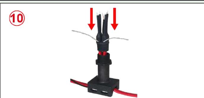
**10:** Far scorrere le guaine isolanti sui conduttori dei cavi scaldanti, lasciando all'esterno il conduttore di terra.
