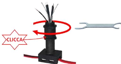
11: Comprimere la guarnizione avvitando la parte superiore del piede. Al termine del serraggio, una piccola molla blocca l'assemblaggio (per lo smontaggio è necessario rimuovere questa piccola molla semicircolare).
