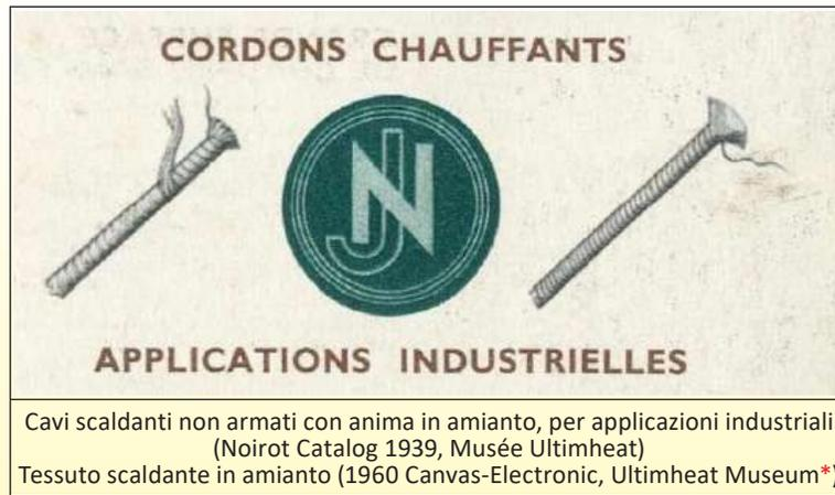
*Un'altra importante applicazione è quella dei cavi riscaldanti, costituiti da una perlina di amianto calibrata sulla quale è avvolto il conduttore metallico e ricoperta (o meno) da una treccia di amianto o da altre sostanze isolanti". (1966 Electric Heating elements, Ultimheat Museum\*)*
