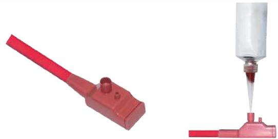
**10:** Posizionare l'armatura su una superficie orizzontale e riempire con silicone RTV liquido attraverso l'imbuto di riempimento fino a quando il silicone inizia a salire nella piccola apertura di degassificazione. Lasciare polimerizzare per circa 24 ore.
