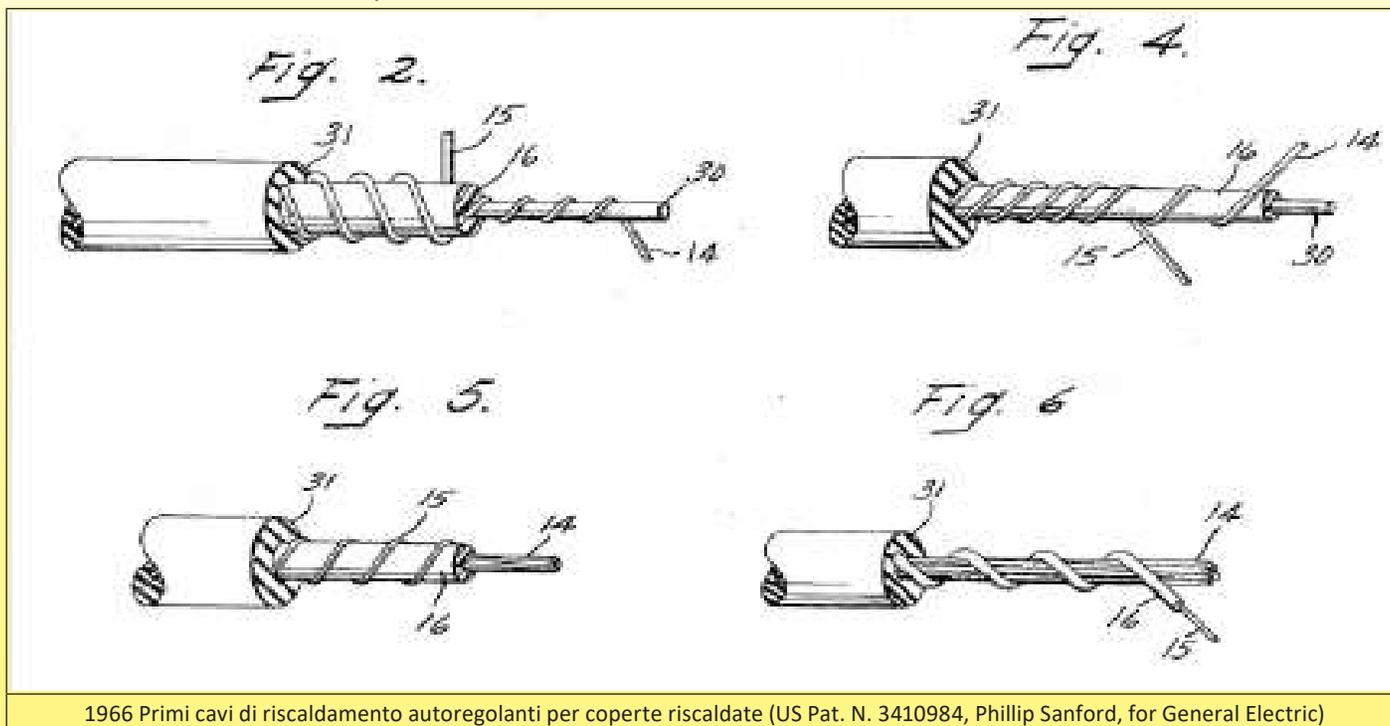
1966 Primi cavi di riscaldamento autoregolanti per coperte riscaldate (US Pat. N. 3410984, Phillip Sanford, for General Electric)
