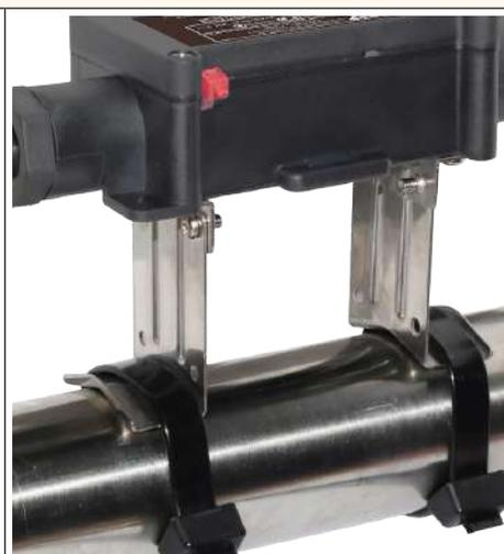
**3:** Una staffa in acciaio inox, per il montaggio sfalsato sulle tubazioni, che consente di bloccare l'alloggiamento dopo l'installazione dell'isolamento e della sua protezione. Consente uno spessore di isolamento di **50mm** e può essere utilizzato su tubi caldi. Il fissaggio su tubazioni in metallo o PVC avviene tramite fascetta in nylon o morsetto metallico. (Le gambe sono disponibili come accessorio).
