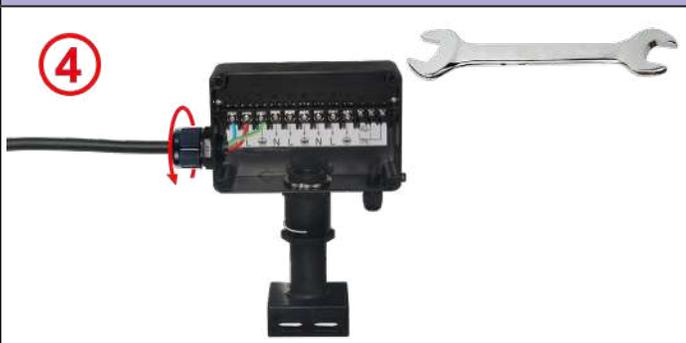
**4** : Far scorrere la guarnizione rotonda del cavo nel pressacavo e serrare il dado. Coppia massima 6N·m.
