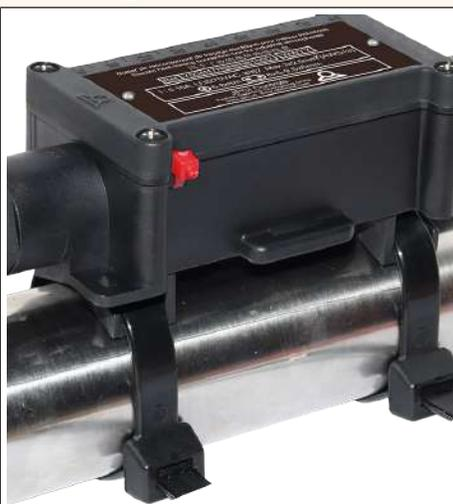
**2:** Due linguette rimovibili in plastica PA66, per il montaggio su tubi, con uno scostamento di **10mm** dal tubo. Ideale ed economico per applicazioni con basso spessore di isolamento e temperatura del tubo inferiore a **100°C**. Il serraggio su tubazioni in metallo o PVC può essere effettuato tramite fascetta in nylon o morsetto metallico (queste linguette sono incluse come standard).
