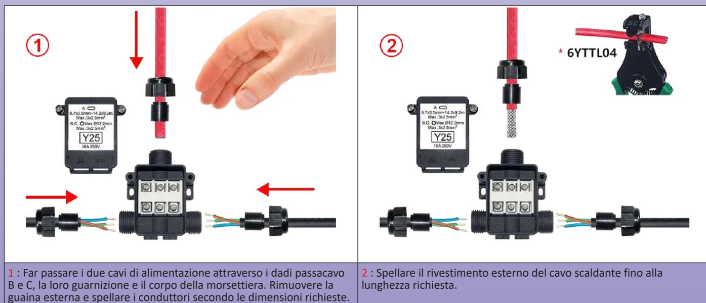
**1** : Far passare i due cavi di alimentazione attraverso i dadi passacavo B e C, la loro guarnizione e il corpo della morsettiere. Rimuovere la guaina esterna e spellare i conduttori secondo le dimensioni richieste.
