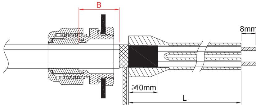
La distanza **B** deve essere mantenuta al minimo per evitare di riscaldare l'interno dell'armadio. La lunghezza **L** dipende dalla distanza dai terminali di collegamento.
