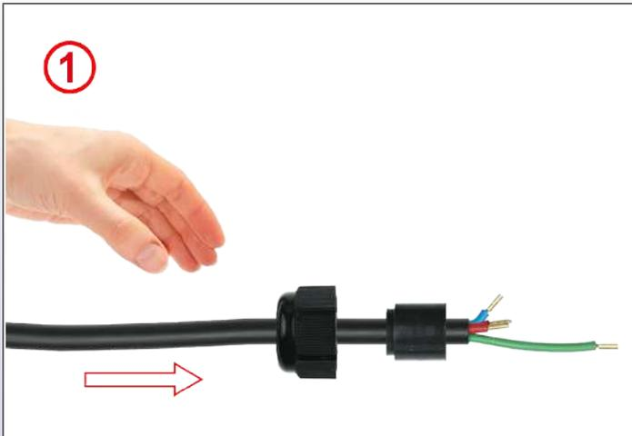
**1** : Rimuovere l'isolamento esterno del cavo tondo come richiesto dal disegno. Eventualmente, crimpare le scarpette del cavo. Far scorrere il dado del pressacavo sul cavo. Selezionare la guarnizione di diametro compatibile e farla scorrere sul cavo.
