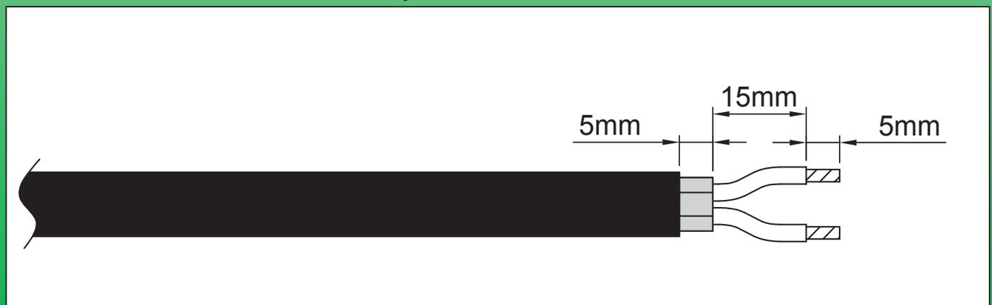
Guaine in silicone per il collegamento dei **cavi scaldanti e dei cavi di alimentazione dei termostati** (montaggio sul campo o in officina). Installazione sull'estremità libera del cavo scaldante, per cavi scaldanti oblunghi, limitatamente ai **modelli della serie con due fili bus affiancati**. Collegamento mediante saldatura. Sigillatura del collegamento mediante guaina in silicone + RTV.
