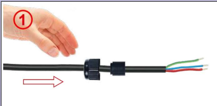
**1** : Rimuovere l'isolamento esterno del cavo tondo come richiesto dal disegno. Eventualmente, crimpare le scarpette del cavo. Far scorrere il dado del pressacavo sul cavo. Selezionare la guarnizione di diametro compatibile e farla scorrere sul cavo.
